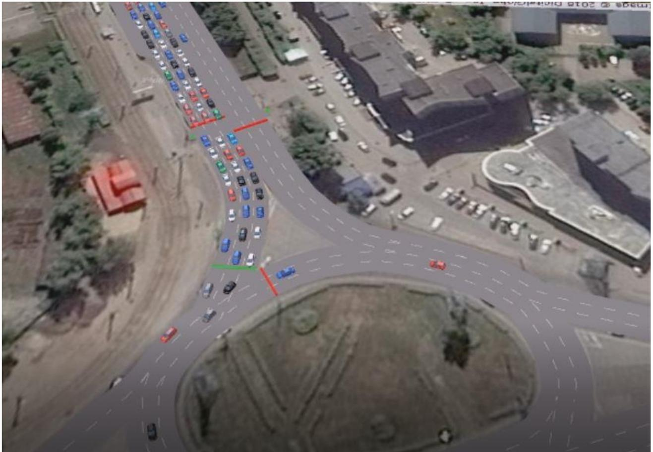
Рисунок 89 - Скриншот динамического моделирования существующего состояния
